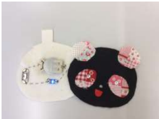
←LEDを光らせる回路を布の上で実現
