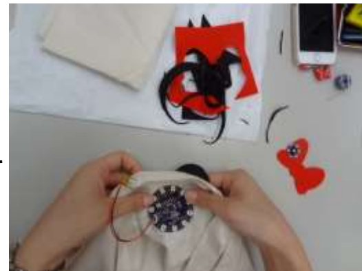
←LEDを光らせる回路を布の上で実現
