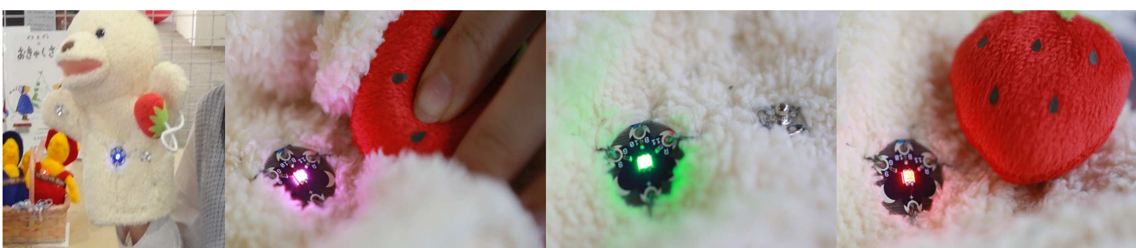
写真1:手で接点を変えることでLEDの色が変わるマペット(ステップ1)
