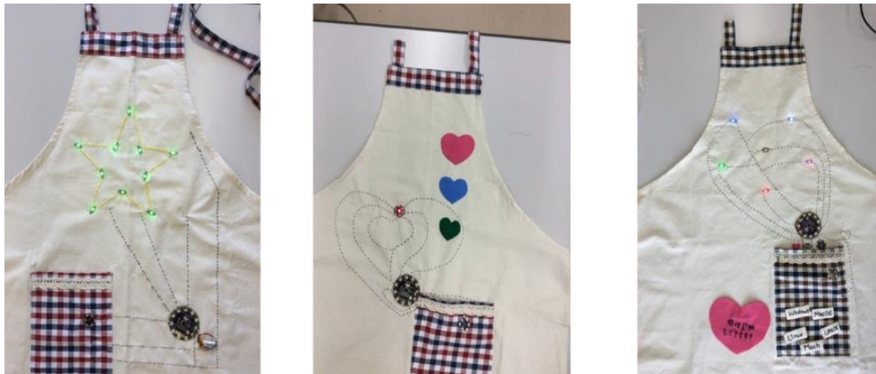
LilyPad 研究会の学生と作った、相性診断エプロン(2015年8月のOSC出展。マイコンとLEDが導線糸で縫い込まれており、プログラムに対応して光る)
